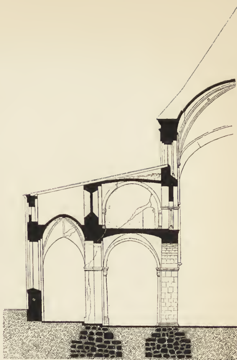
MURVÆRKETS TILSTAND FØR ISTANDSÆTTELSEN.
