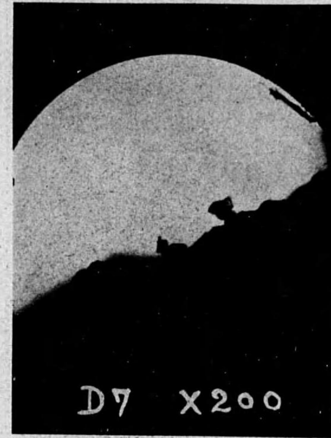
圖版 16 ×200 2601 II 4 22'00 m 瓦片を冷却した際に生じたる霜 D7 X200
