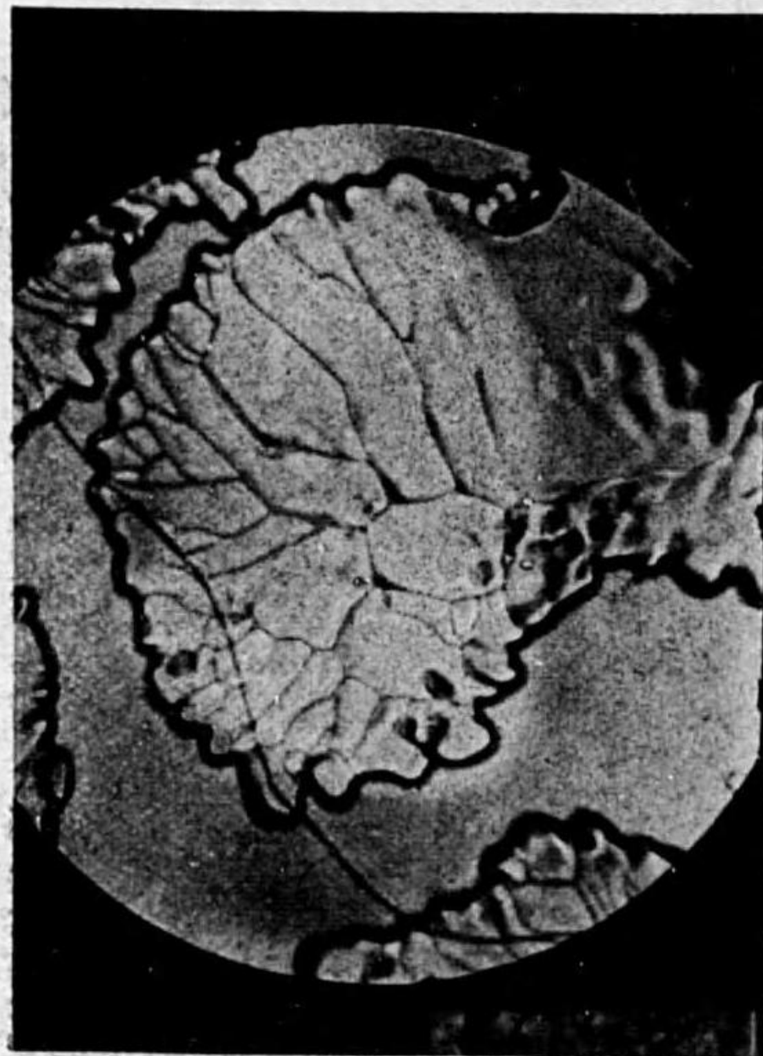
圖版 7 \times 200 2601 II 16 23 h 30 m 赤土霜柱の上に硝子を置きその下面に生じたる霜
