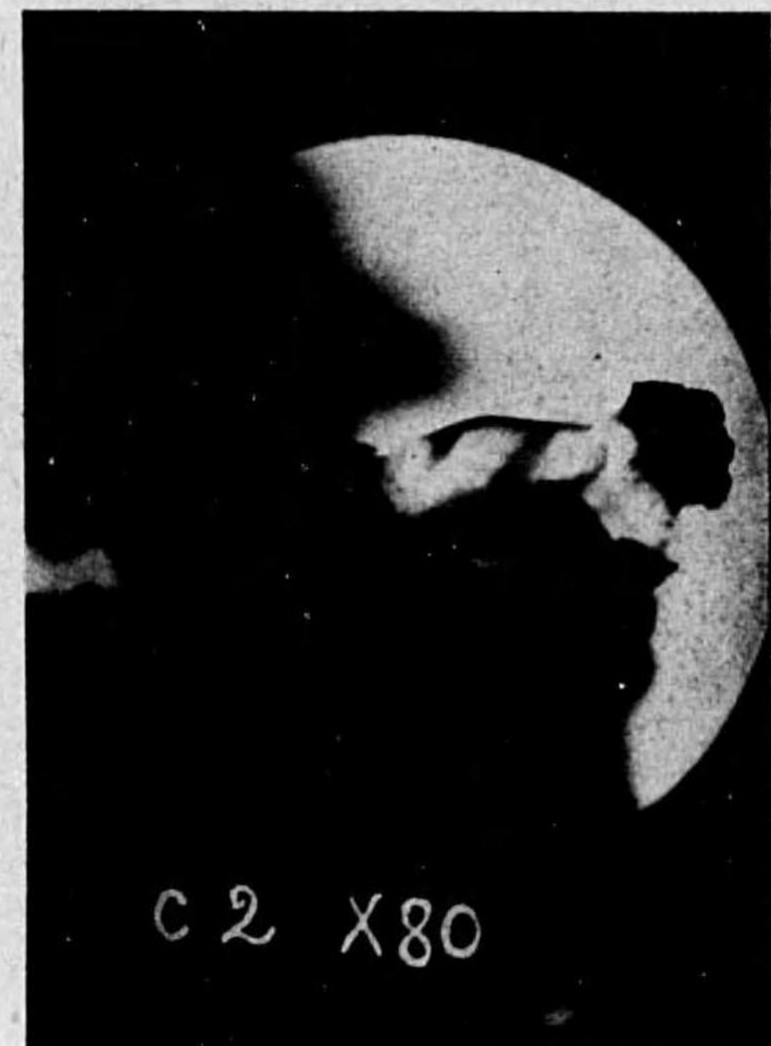
圖版 18 ×80 2601 II 2 18'40 m 赤土に生じたる筈状霜柱 C2 X80
