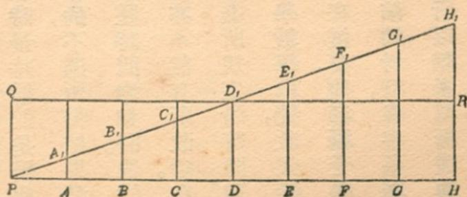
代替下墜運動，這等速運動的速度當等於下墜運動最後速度之半，故如下墜空間為  $s$ 、 $S$ ，其相當的最後速度為  $v$ 、 $V$ ，以及時間為  $t$ 、 $T$ ，則在無阻的下墜方面，即有
