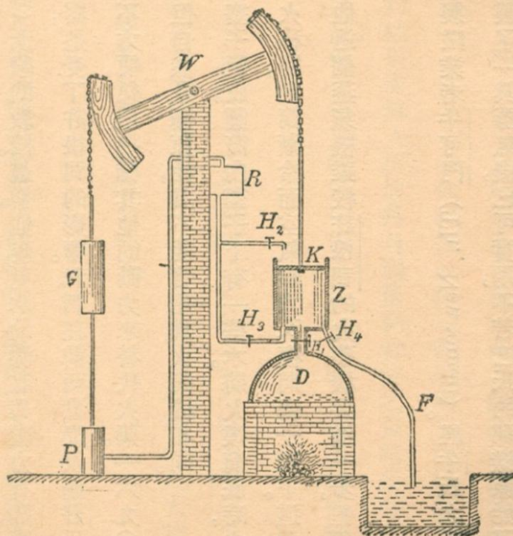
樣一來，蒸汽機工作能力又復增加。圖中所示的H及F即為將Z中水重復放出的機關。一七一〇年時的蒸汽機便是這個狀況。應用此項機器時，必須用兒童司開關H、H<sub>3</sub>等之職。
