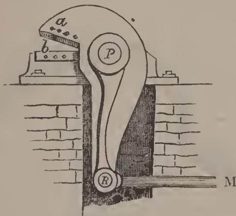
Fig. 2.—Shears for Cutting Bar Iron.
