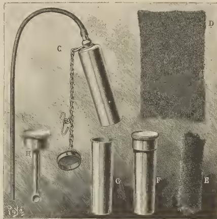
Fig. 3. - Diversos órganos del filtro de bolsillo de Delsol y Fillard
