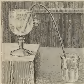
Fig. 1. - Funcionamiento del filtro de bolsillo de Delsol y Fillard
