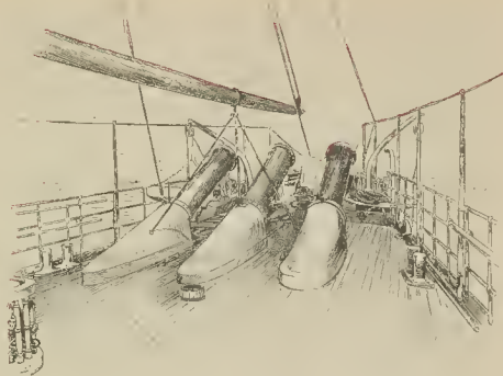
Parte de los tres cañones neumáticos del Vesubius que sale por fuera de la cubierta
