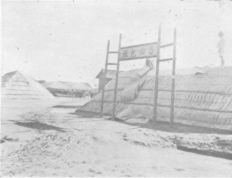
24 呂四場同仁泰公司製鹽用板晒法，圖示堆鹽成廩之情形
