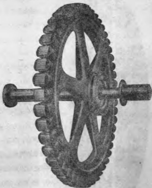
(第 198 圖。水輪發電機之旋轉磁場。)
