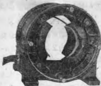
【第 66 圖 二極電動機之機架。顯示磁場繞圈與磁極。】
