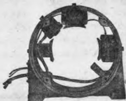
(第104圖。直流發電機之機身及主要磁極與內開極之裝置。)
