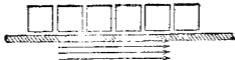
(第 122 圖。緊繞之線圈，可想像由長方形電線所構成，區與區間有薄絕緣體。)
