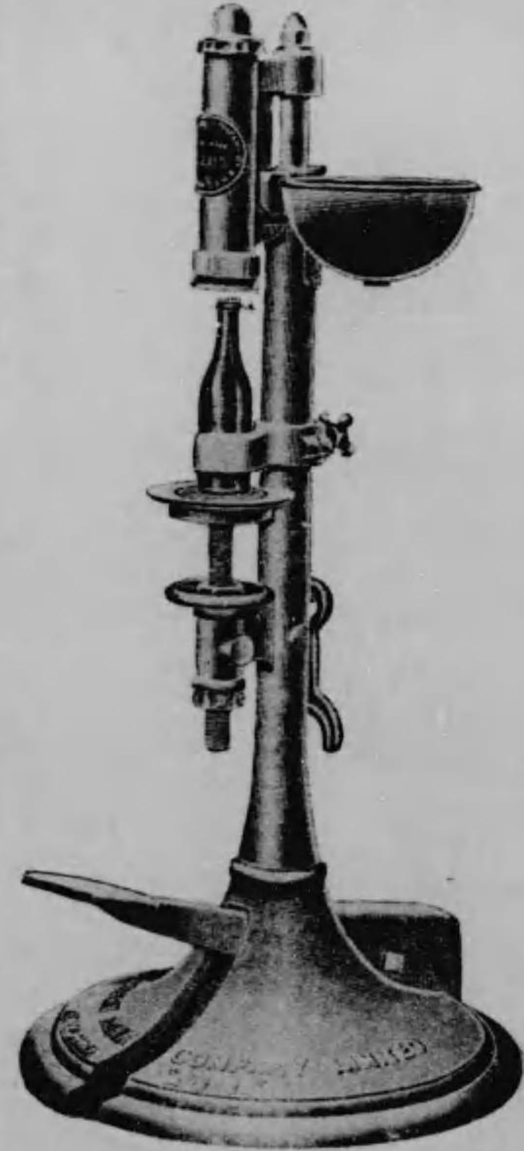
(踏足)機栓打ウラク
