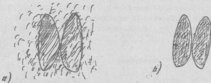
Rys. 5.11. Efekt eliminacji tła. Po lewej scyntygram płuca wykonany przy zachowaniu rejestracji wszystkich sygnałów, po prawej ta sama rejestracja przy usunięciu wszystkich sygnałów o mocy mniejszej niż 10% sygnału maksymalnego
