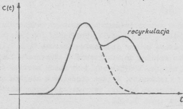
Rys. 3.38. Zniekształcenie krzywej przejścia indykatora przez zjawisko recyrkulacji
