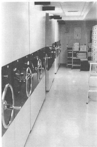
圖 4-8 微縮片貯存庫內密集式活動貯存架
