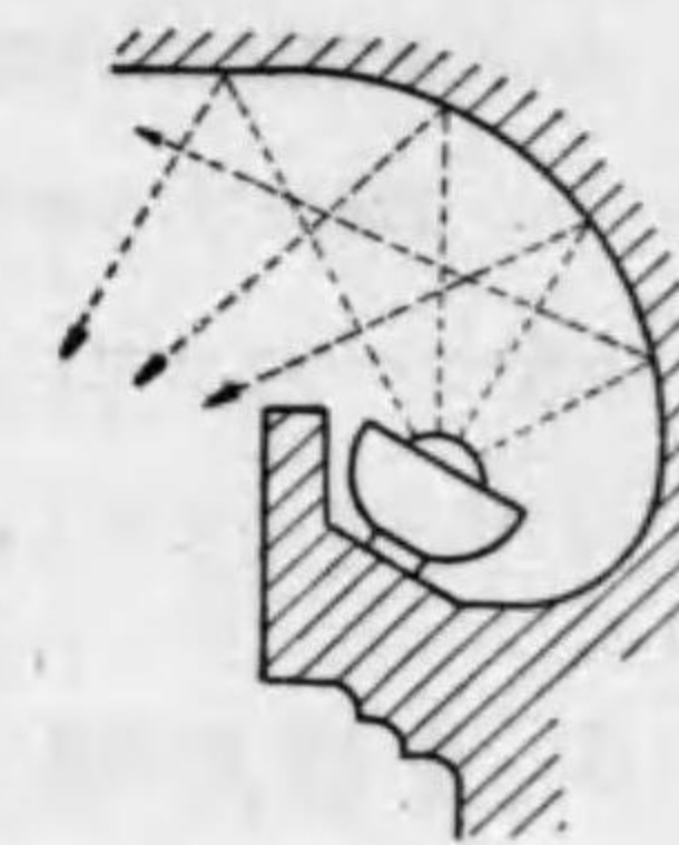
間接照明装置
