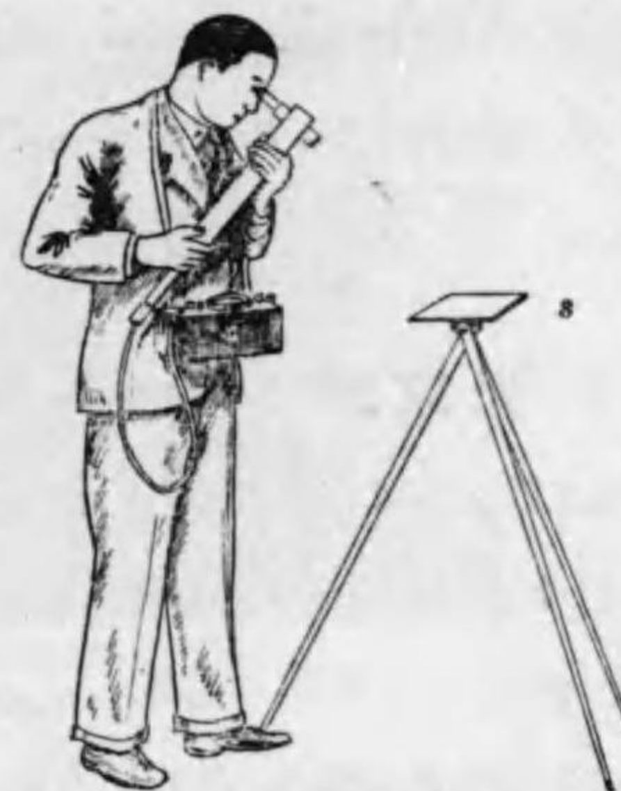
マクベス照度計で s の照度を測定中の圖
