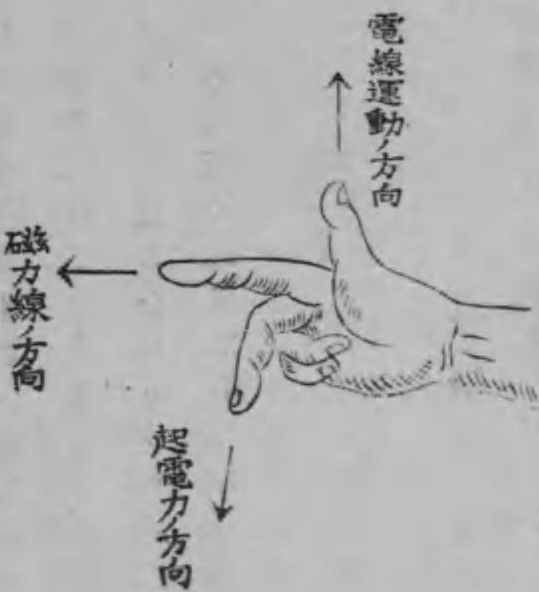
第七圖 誘發起電力と磁力線との關係
