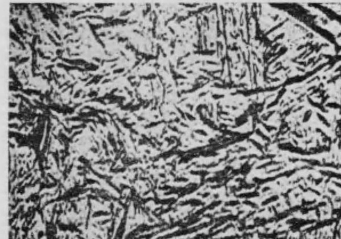
(6) 稍 ヲ 過 熱 セ ル 健 淬 組 織 健淬温度 850度 硬 度 95
