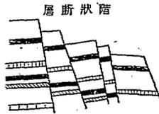
連長綿互而成山的，叫做斷層山脈(Fault Mas)；中間之地下陷，而左右之地仍保持其位置的，叫做渠狀斷層(French Fault)或地溝(Grahen)；地形中陷，斷層綫
