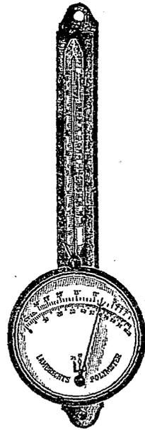
溼度表，分上下二種數字，下方數字表示溼度，上方數字表示氣溫和露點(Dew Point)的差度。
