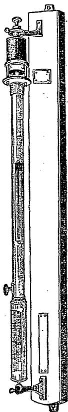
小，水銀下降，即爲低氣壓。此器測量最爲精密，惟價昂且不便郊外攜帶。(2)空盒氣壓表 (Aneroid Barometer)，是用金屬製小而薄的空盒，盒中空氣，盡行抽去，成爲真空。外界氣壓高，盒面凹入，便傳達到指針，指示他的度數。攜帶雖
