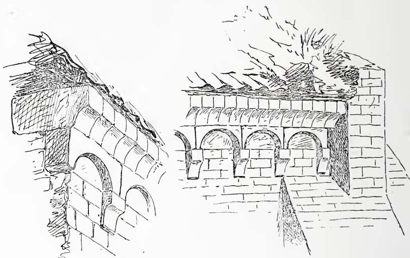
Détails de la corniche en briques moulurées de la grange. (Ferme de Bogaerde).
