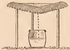
Fig. 112. Methode der Salzauslaugung aus dem rothen Thon bei Tsing-tschou.
