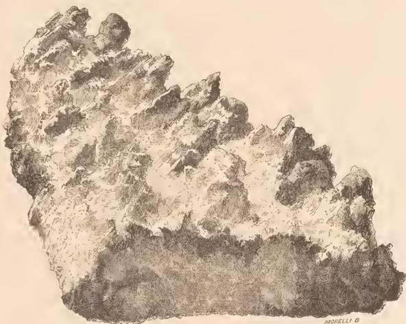
Fig. 43. Ein durch Sandwehen angefressenes Ziegelstück.
