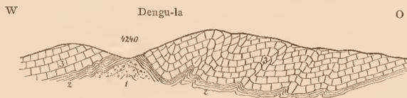
Fig. 139. Profil durch das obere Ende des Thales von Tz-de unterhalb des Dengu-la-Sattels.
