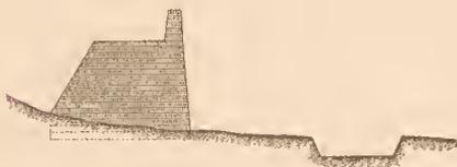
Fig. 84. Querschnitt durch die grosse Mauer in der Nähe von Ping-fan-shien.
