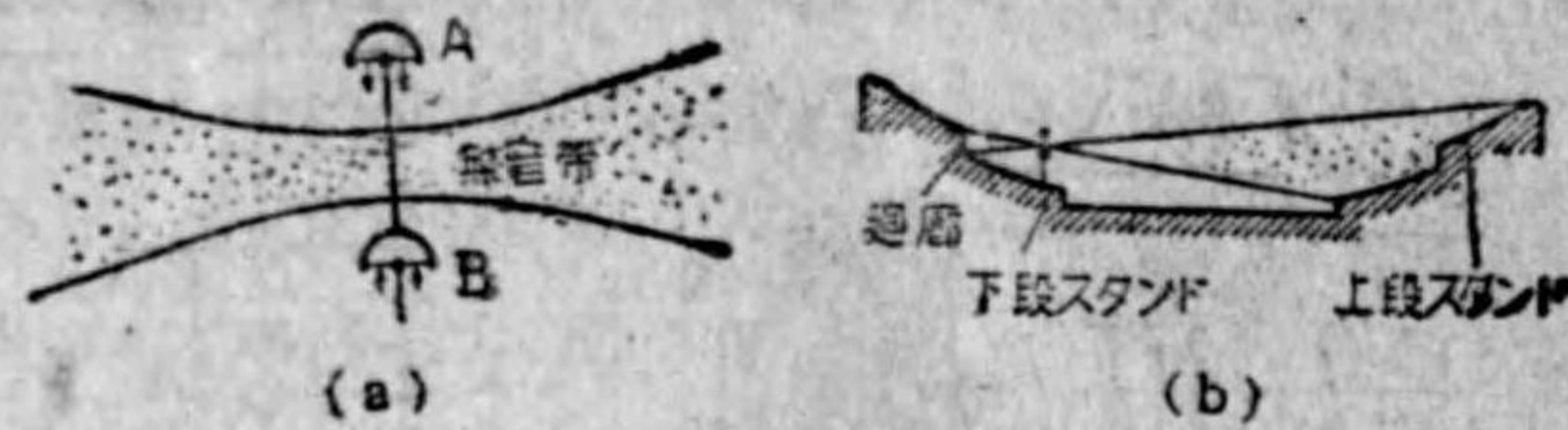
ダイポール・スピーカーによる音響反射の除去
