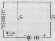
圖 73. 說明電感之電路。
