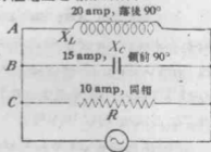
圖 27. 假設中具有純電感，電容與電阻之電路。
