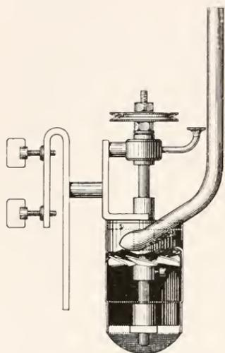
Fig. 14. Zentrifugalpumpe.
