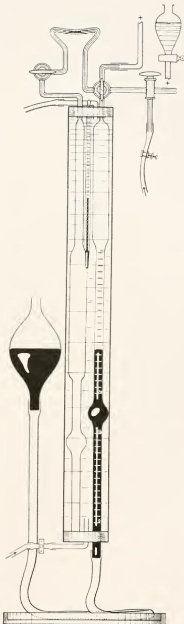
Fig. 16. Gasbürette zur Analyse großer Volumina.
