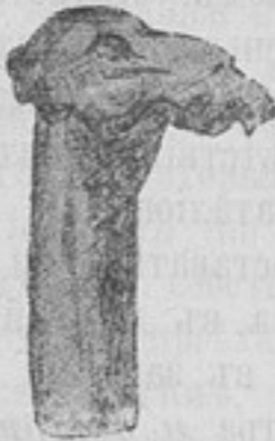
Черт. 6. Пуля съ пустой головкой, выстрѣленная съ разстоянія около 150 метр. въ твердыя и сухія тѣла, напр., въ дерево, кости и т. п. (въ натур. величину).
