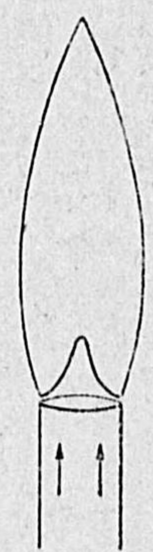
ブ ン ゼ ン 燈 の 山 形 の 焰 の 内 心 處 の 平 衡 す。 定 常 焰 の 内 心 處 の 平 衡 す。
