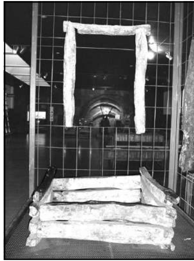
Рис. 3. Греція. Оригінальне дерев'яне кріплення мідних рудників Кіпру (V ст. до Р.Х.) [Німецький гірничий музей в Бохумі]
