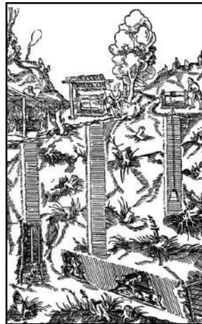
Рис. 4. Німеччина. Способи проходки вертикальних виробок (за Г.Агріколою, 1556 р.)
