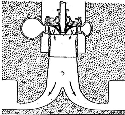
圖 197 謨提的發散排水管
