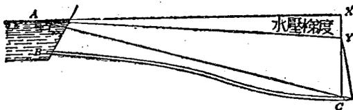
圖 116 不同放出率所形成的變動水壓梯度
