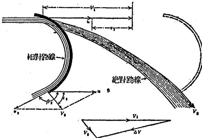
圖 158 水在運動輪葉上的作用
