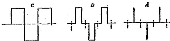
圖 165 在理想情形下立閉所生的壓力變化
