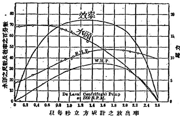
圖 242 在一定速率下之六吋抽機的特性曲線
