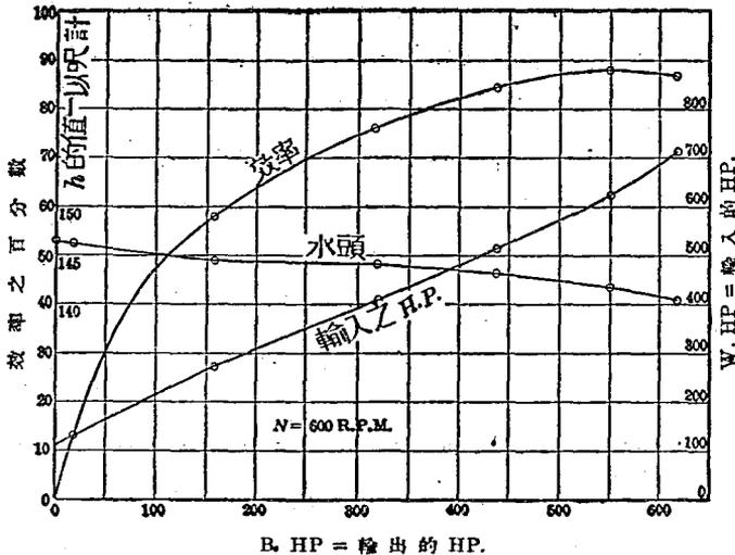
圖 223 27 吋皮摩利斯輪機的試驗。水頭與  $\phi$  近似不變。水門開口是變化的。
