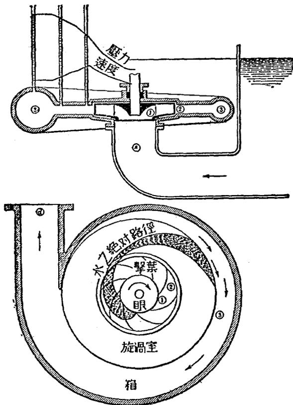
擴大的通路，牠們的功用在於減小水離擊葉時的速度，如是即可使速頭變為壓頭的效率加大，環繞發散器之箱，與擊葉作成同心圓形，或者像反作用輪機的螺形箱都可以。
