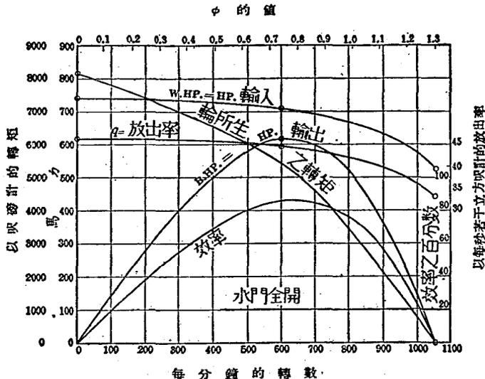
圖 222 27吋愛皮摩利斯輪機的試驗。水頭及水門開口固定不變。速率是變動的。(註一)
