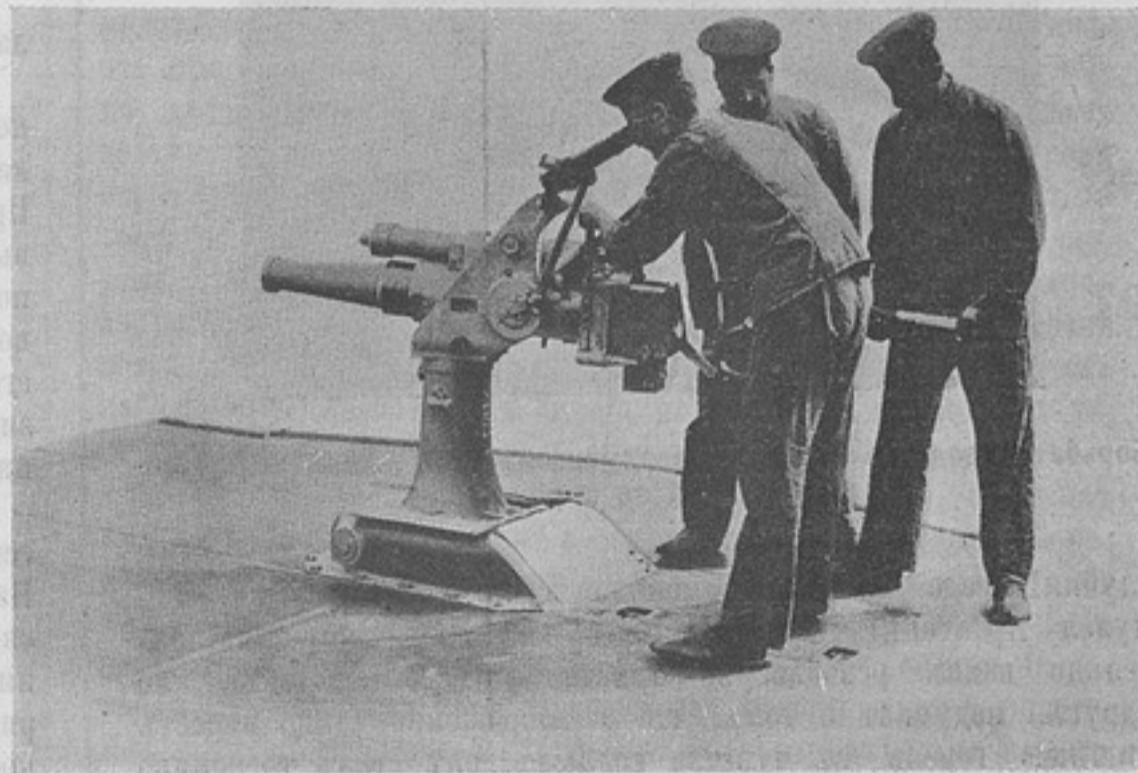
Новое вооруженіе подводныхъ лодокъ. „Появляющаяся“ пушка для борьбы съ воздушнымъ флотомъ. Изготовлена для стрѣльбы подъ нормальнымъ угломъ возвышенія.
