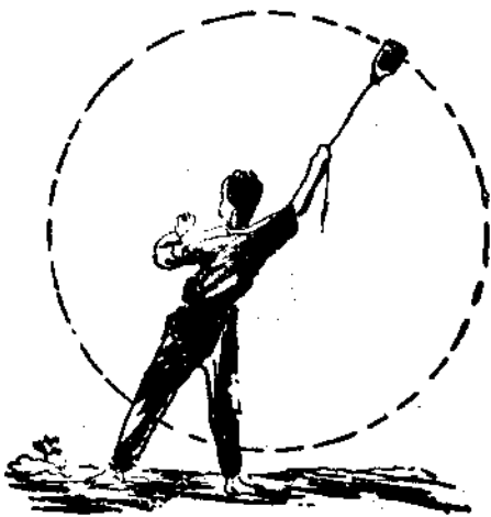
第一二圖 用繩繫住石子旋轉。繩子一斷，石子便一直線的飛出去。
