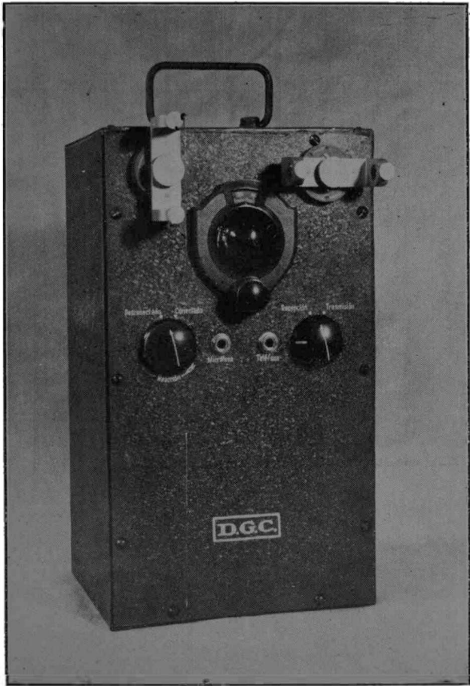
**Transmisor receptor de Ondas ultracortas 56 M. Hz. (5 m.). (Frente)**
