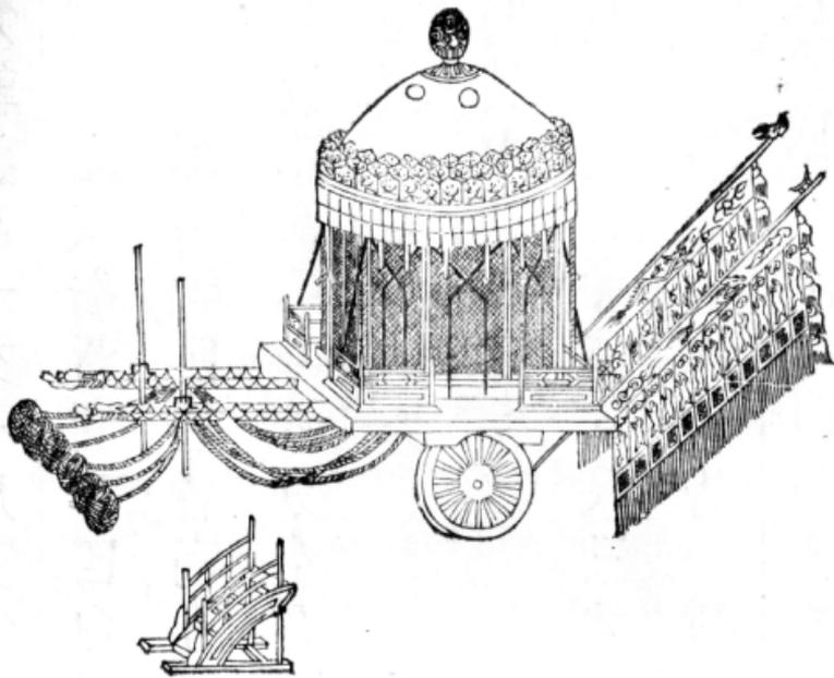
革輅圓蓋方軫通高一丈一尺三寸蓋高二尺五寸五分飾以泥銀銜黃圓革四白緞垂幃三層繫白緞帶四屬於軫四柱各高五尺五寸九分門高五尺闊二尺二寸五分左右門闊二尺一寸九分座縱一丈六寸橫八尺三寸五分環以朱欄各闕其中二尺三寸轅二各長一丈九尺五分軫長一丈六寸徑八尺三寸五分後建大白十有二旂各繡金虎服馬一驂馬三設游環和鈴餘如玉輅之制。
