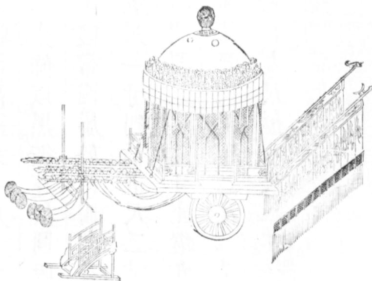
木輅。圓蓋。方軫。通高一丈一尺六寸五分。蓋高二尺六寸一分。飾以黑。銜花梨圓版四。黑緞垂幃三層。繫黑緞帶四。屬於軫。四柱各高六尺五分。相距各五尺一寸。門高五尺二寸。闊二尺二寸五分。左右門闊二尺二寸。座縱九尺。橫八尺八寸。環以朱欄。各闕。其中二尺二寸。轅三。各長二丈一尺。軫長九尺。徑八尺八寸。後建大麾十有二旂。各繡神武。服馬二。驂馬四。設游環和鈴。餘如玉輅之制。
