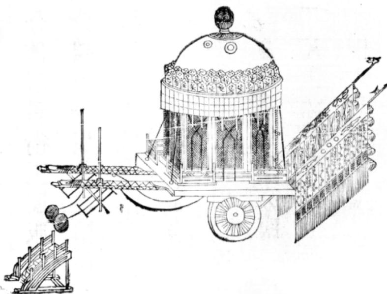
玉輅木質髹朱。圓蓋方軫。通高一丈二尺一寸。蓋高三尺一分。飾以青。銜玉圓版四。冠金圓頂一尺二寸九分。鏤金垂雲承之。檐徑八尺一寸。周貼鏤金雲版三層。青緞垂幃亦三層。各深五寸。繡金雲龍間以羽文。繫繡金青緞帶四。屬於軫。四柱各高六尺七寸九分。相距各五尺六寸。繪以金龍門。高五尺一寸九分。闊二尺四寸九分。左右門闊二尺二寸五分。垂朱簾。四面各三座。縱八尺五寸。橫八尺四寸。環以朱欄。飾間金采。其高一尺六寸五分。各闕其中二尺四寸。欄
