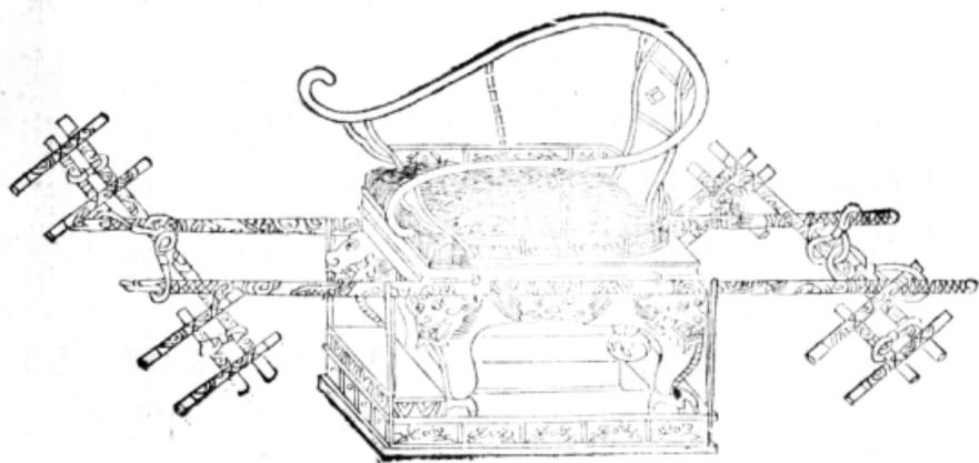
步輿木質塗金。不施幃蓋。通高三尺五寸。倚高一尺六寸五分。鏤花文中。爲蟠龍座。高一尺八寸五分。縱一尺八寸。橫二尺二寸。冬施紫貂坐具。夏以明黃氍毹。四足爲螭首虎爪。承以圓珠。周繪雲龍。踏几高三寸一分。縱九寸五分。橫二尺二寸。籠以黃緞。底縱三尺。四面爲橫距直轅二。各長一丈五尺五寸。大橫杆二。各長七尺六寸。中爲雙龍首相對。小橫杆四。各長二尺八寸。肩杆八。各長五尺六寸。飾如禮輿之制。亦昇以十六人。
