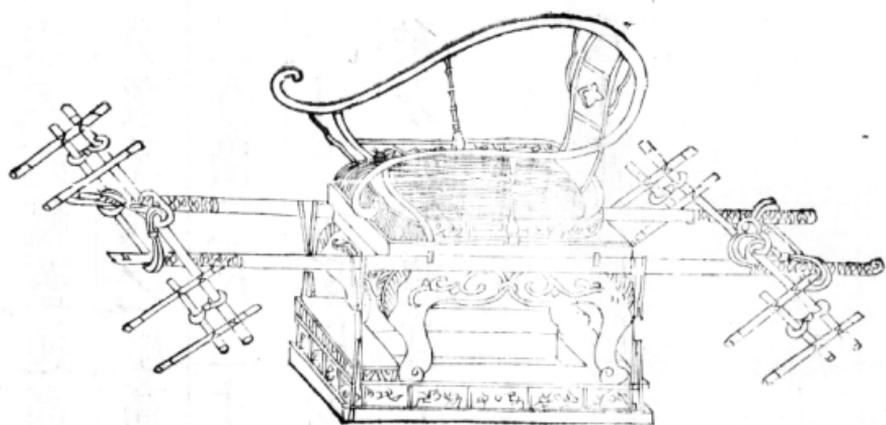
輕步輿。木質髹朱。不施幃蓋。通高三尺四寸。倚高一尺五寸八分。象牙爲之。座高一尺八寸二分。縱一尺八寸三分。橫二尺二寸。踏几高三寸。縱九寸。橫二尺一寸五分。髹以金。直轅二。各長一丈五尺四寸五分。加銅龍首尾。大橫杆二。各長九尺一寸。小橫杆四。各長二尺八寸四分。肩杆八。各長五尺八寸五分。皆鈔以銅。餘如步輿之制。亦鼻以十六人。
