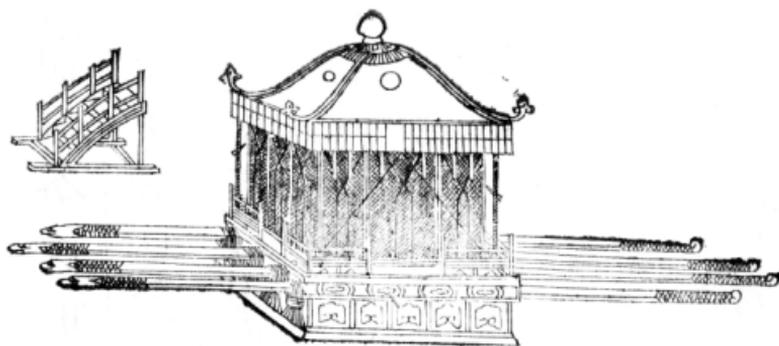
金輦。圓蓋。方軫。通高一丈五寸。蓋高一尺九寸。飾以泥金。銜金圓版四。冠金圓頂一尺。檐徑七尺一寸。黃緞重檐。各深五寸。柱高五尺。相距各四尺九寸。門高四尺七寸五分。闊二尺二寸五分。冬垂黃氈幃。夏易以朱簾。黑緞緣。四面各三座。下方七尺五寸。上方七尺三寸。環以朱欄。其高一尺三寸。各闕其中二尺三寸。轅四。內二轅長二丈八尺一寸。外二轅長二丈六尺一寸。昇以二十八人。餘如玉輦之制。
