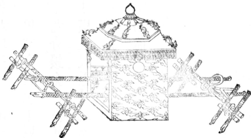
禮輿。枅質。通高六尺三寸。上爲穹蓋二層。高一尺三寸。上層八角。飾金行龍。下四角。飾亦如之。冠金圓頂八寸九分。鏤金垂雲承之。銜以雜寶。檐縱四尺七寸。橫三尺五寸。明黃緞重檐。各深八寸五分。繡金雲龍。四柱各高五尺。縱距三尺九寸。橫三尺。飾蟠龍。門端及左右欄飾雲龍。皆鏤金。內爲金龍寶座。高一尺七寸。縱二尺一寸。橫二尺七寸。倚高二尺二寸。幃用明黃雲緞。紗氈各惟其時。左右啟櫺。夏以藍紗。冬以玻璃。直轅二各長一丈七尺六寸五分。大橫杆二各長
