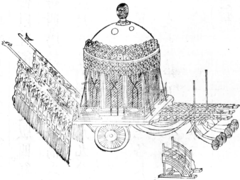
象輅圓蓋方軫。通高一丈一尺三寸。蓋高二尺六寸五分。飾以紅。銜象牙圓版四。紅緞垂幃三層。繫紅緞帶四。屬於軫。四柱各高六尺四寸九分。相距各五尺八寸。門高五尺九分。闊二尺四寸五分。座一一丈五分。橫九尺一寸。環以朱欄。各闕其中二尺二寸五分。轅三。各長二丈二尺三寸。軫長一丈五分。徑九尺一寸。後建大赤十有二旂。各繡金鳳。服馬二。驂馬六。設游環和鈴。餘如玉輅之制。
