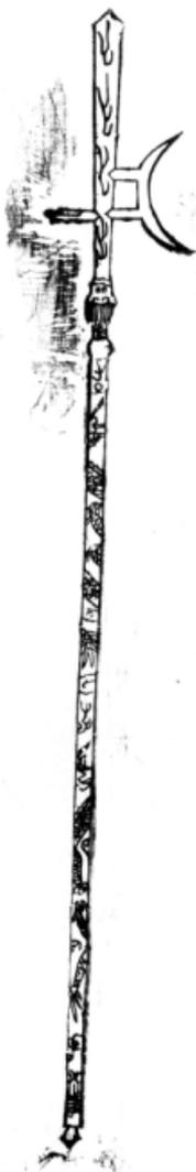
戟。鍛鐵。通長一丈一尺。援長一尺三寸。胡外曲。徑七寸三分。中有觚。觚上橫二寸五分。下橫五寸。內外各半。外鏤龍首。釜長九寸。鏤龍首上銜。通塗以金。柄長八尺。餘如豹尾槍之制。
