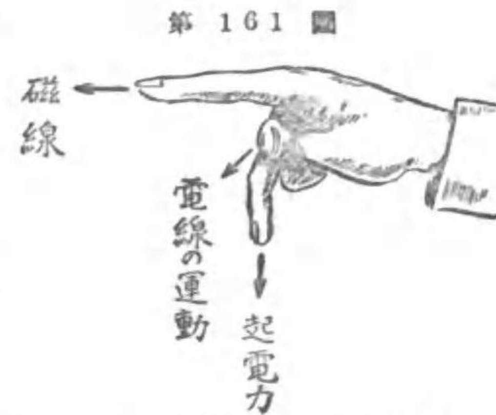
磁線を切つた時の起電力の方向を知る法 (フレーミングの右手三指の規則)
