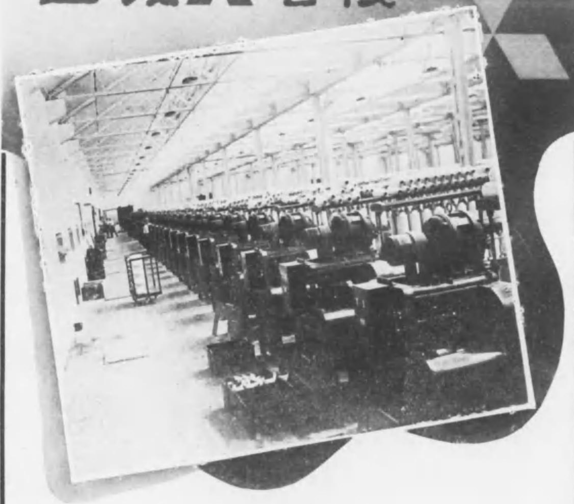
弊社紡績用高率モートルによつて單獨運轉されつゝある精紡機
