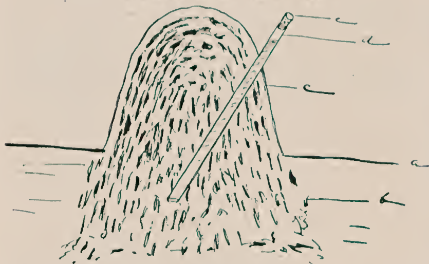
FIGURA 17 — Desenho schematico mostrando o modo de applicar o bisulfureto de carbono (formleida Capanema). a — nivel do solo; b — parte subterranea do formigueiro; c — parte aerea do formigueiro; d — tubo collocado no formigueiro e por onde se introduz o formleida; e — rolha com que se tapa o tubo, logo depois de introduzido o formleida.
