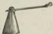
FIG. 133.—Plombée à anse de florence et à coulant.
