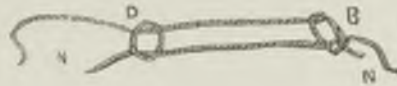
FIG 174.— Nœud anglais non serré, entre les nœuds D et E duquel on introduit l'extrémité de l'empile.
