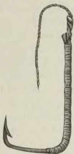
FIG. 70.—Hameçon carré (suisse), à pointe droite ; forme très recherchée pour la pêche aux lignes de fond sur le lac de Constance. Ces hameçons ne reçoivent qu'une trempe très faible qui leur permet de s'ouvrir facilement sous la traction du poisson. Les pêcheurs prétendent que c'est un avantage pour les pêches où le poisson se prend seul.
