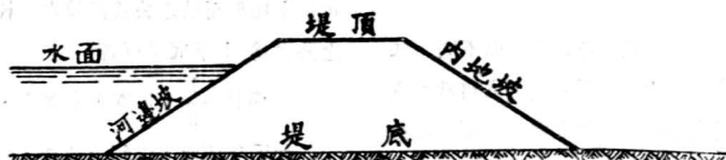
第一圖 堤之橫斷面
