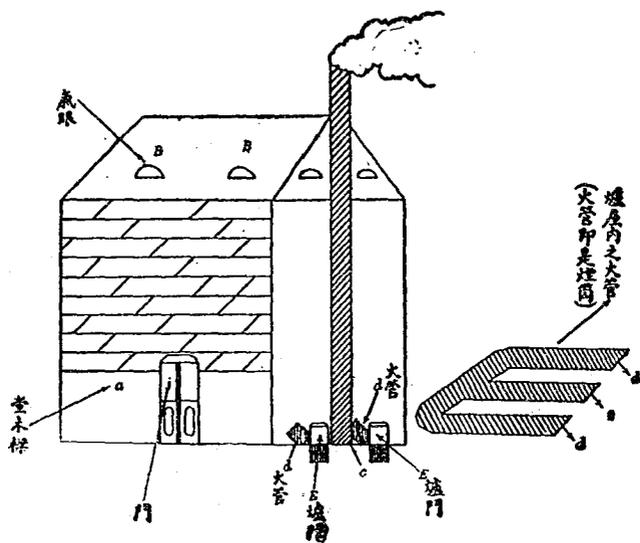
壽光、臨朐，亦各有數千。煙葉之培植，係由東而西，故爐煙之爐屋，亦由東而西漸，爐屋之大小並無一定，普通四平方公尺乃至六平方公尺，室內之地面掘深三四尺，將土運出屋外，更於屋外向地下挖掘一部分，以作爐之燒火口，燃料通用煤炭，煙筒概為磚製，亦有沿屋壁造者，稍突出屋壁頂上一二尺，燒火口於屋內有通路，此通路前多用鐵管，其管長五尺五寸，寬二尺七寸之薄鐵板所製成，口徑七八寸，近則於地內設餞道，上覆以瓦，外塗以石灰或洋灰，為鐵管之代用物，其優點在熱氣適度，不如鐵管之猛烈，且少危險，亦減費用。燒火口普通以寬一尺五寸長二尺之迴轉鐵板作門，便於關閉，以助燃燒。爐屋高一丈乃至一丈五尺，屋內兩面對壁有每間隔一尺五寸乃至二尺之等距離孔，為設木架之用，其孔數之多少，以屋之大小而定，分段設置，段與段之間，相隔三尺，各木架之間，以高梁桿三四根束繫之，煙葉則以五寸間隔兩面懸掛之。
