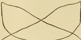
M. E. P., 88.8. M. E. P., 90. I. H. P., 367. I. H. P., 386.
