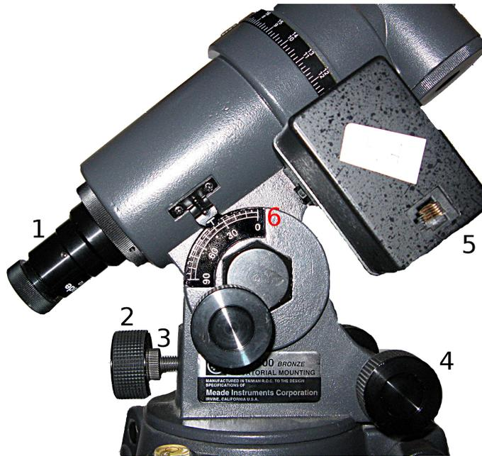
Abbildung 4: Die Montierung: 1.) Polsucher 2.) Feineinstellungsschraube für die Breiteneinstellung 3.) Kontermutter 4.) Azimut-Feineinstellungsschraube 5.) RA-Motor 6.) Breitenskala
