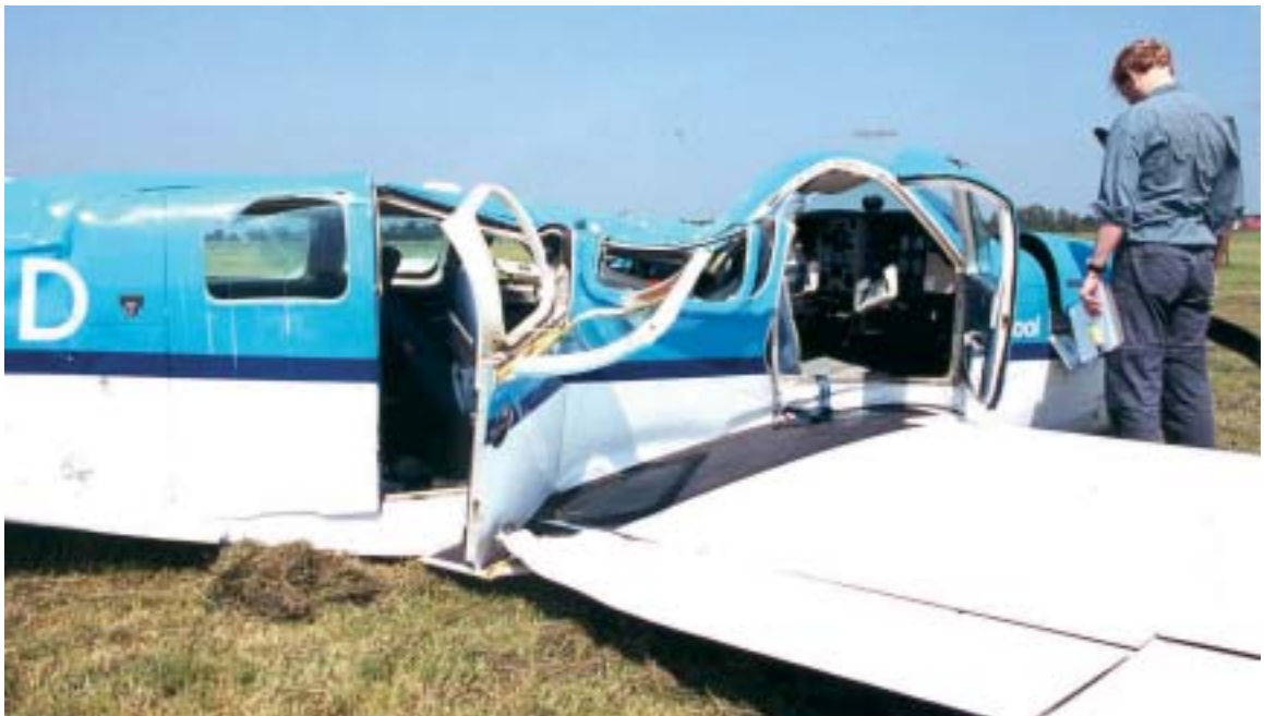
Figuur 2-11: Schade aan het dak van de PH-BWD
