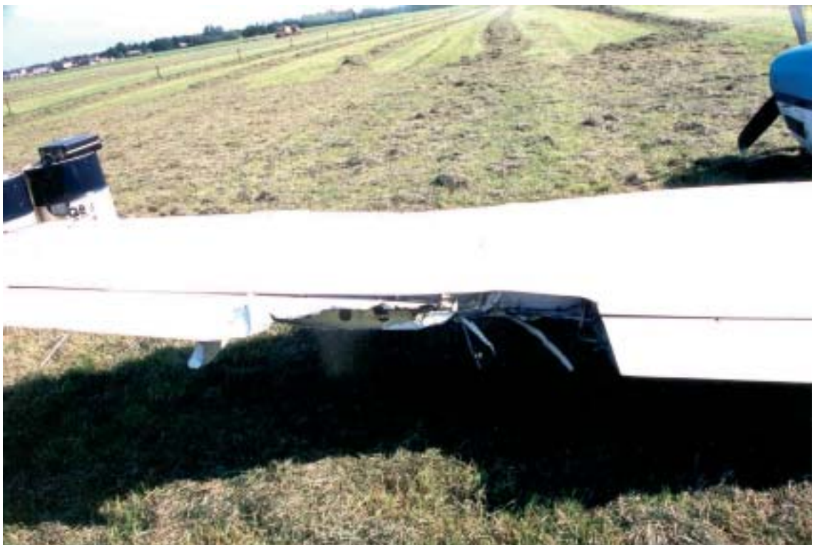
Figuur 2-8: Schade linker rolroer PH-BWD
