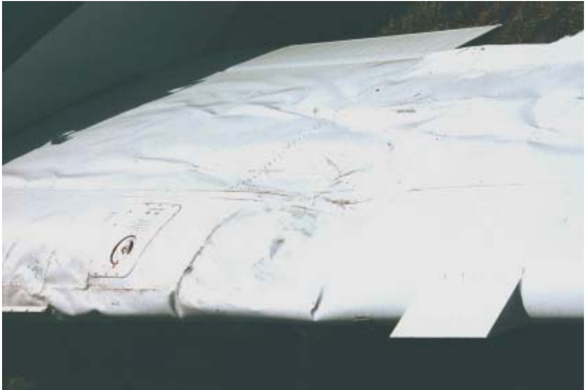
Figuur 2-9: Schade bovenzijde linkervleugel
