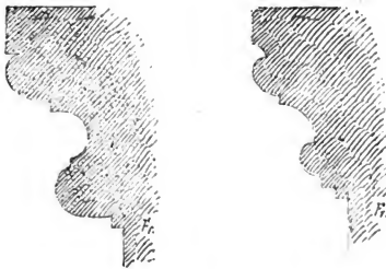
Deckglieder an Säulenkapitälern und Pfeilern im Schiff der Kirche.
