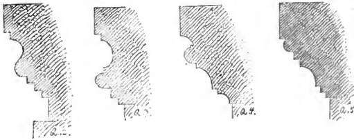
Deckgesimse der Säulenkapitälé
