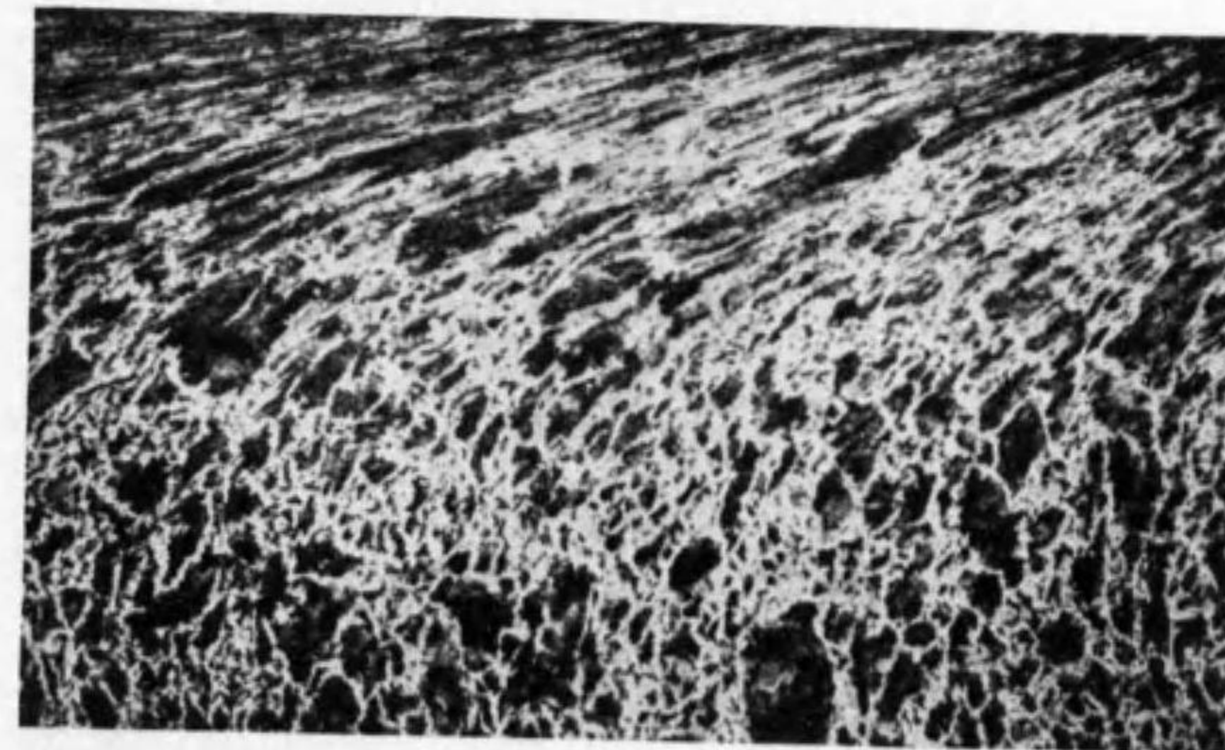
No. 10. No. 9 の荒削りしたものの横断面で、表面の近くが著しく歪んで捻られる事を示す。(×100)
