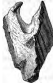
Bruchfläche mit dem Loche.
