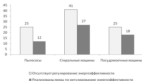
Рис. 3. Сравнение прогноза потребления электроэнергии без реализации мер энергосбережения с результатами, полученными при реализации мер энергосбережения в 2020 г. в странах ЕС (в ТВт · ч/год)
