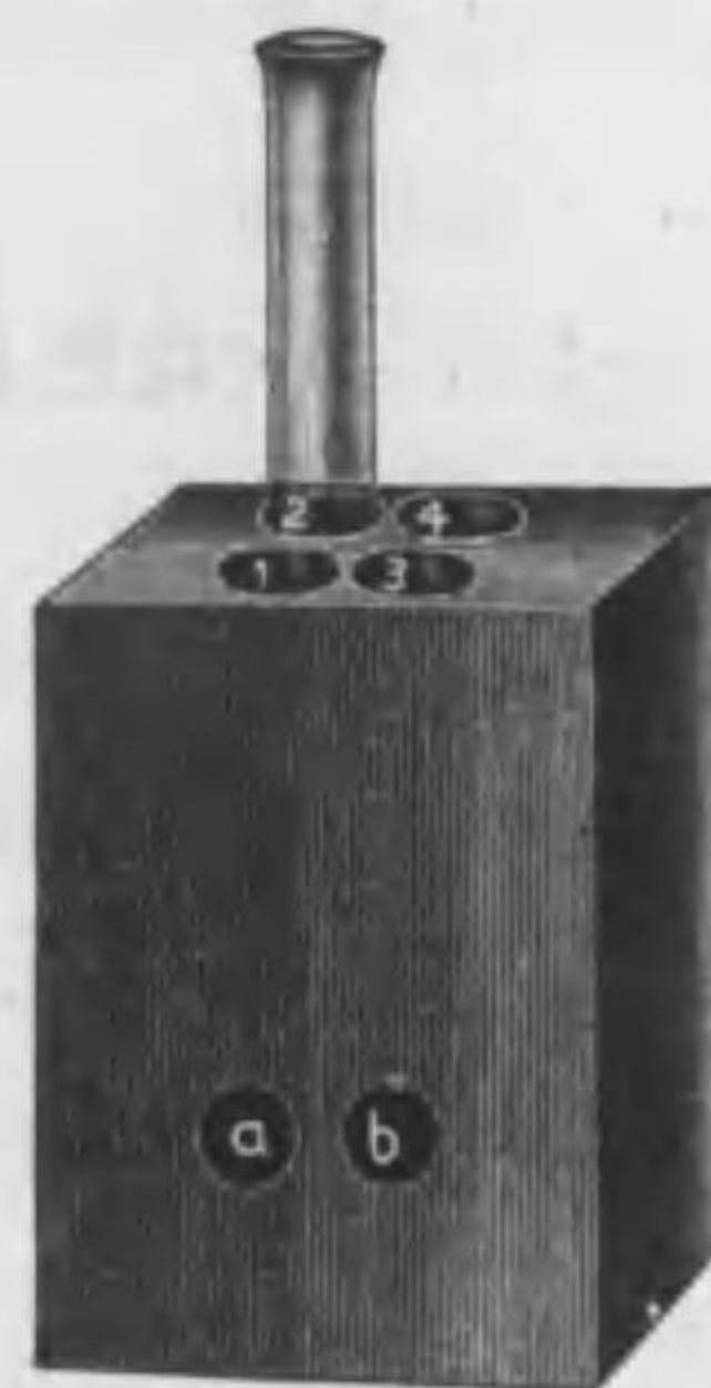
Fig. 112. Michaelis 氏の比色器、 a b なる孔の反対側に 球磨硝子を装置す。
