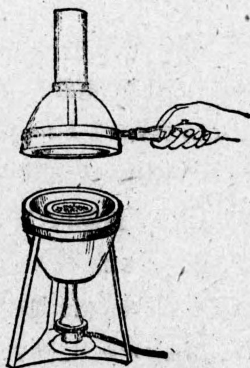
第48圖 アンチモンの製法(坩堝爐)
