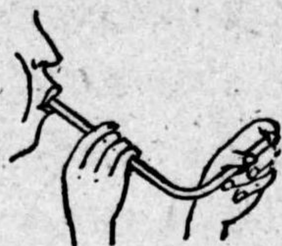
第7圖 硝子管の曲げ方
