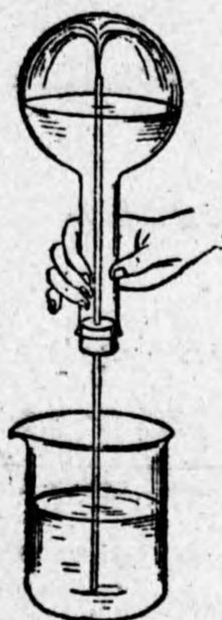
第43圖 アムモニアの水に溶解することによりて生ずる噴水
