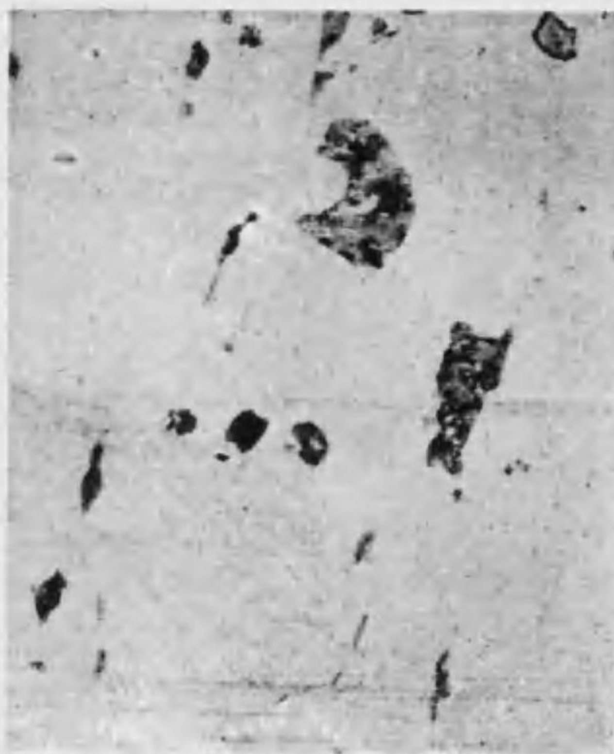
〔説明〕 古く印度でつくられた鍊鐵の顯微鏡組織(50倍に拡大してみたもの)
