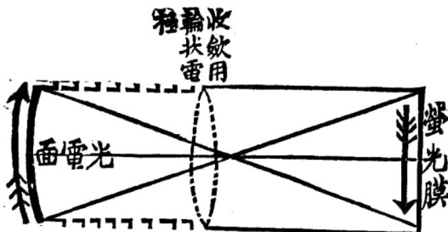
上圖左端爲光電管之光電面，當赤外線照映之際，因照映目的物所呈之強弱電子，即呈同樣之飛動，
