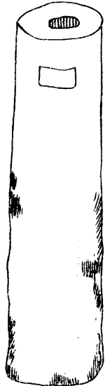
大區標準角之標石 徑七寸長三尺 圓孔徑二寸七深五寸半
