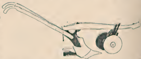
Arado de dois discos curvados, proprio para a cultura da batata doce.
