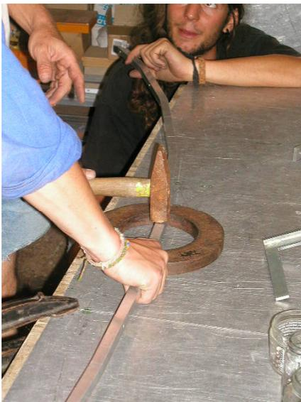
Ensuite, vous devez vérifier si la barre centrale est bien plane. Placer la sur une surface plane. Ainsi, les cotés de la barre centrale doivent être perpendiculaires à la surface, surtout où les barres transversales seront visées. Lorsque ce n'est pas le cas, vous pouvez utiliser un marteau pour corriger comme montré (voir photo).
