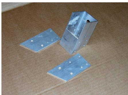
Assembler T1 et les T3's avec des pop rivets comme c'est montré sur les photos. Les bords inclinés (25°) de T1 et T3 sont parallèles.
