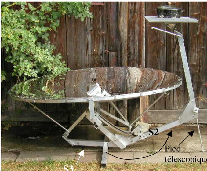
3. **Pied télescopique** (S16, S11, S9 (celui avec le trou de 12mm)): Pour une latitude de ~25°, S2 est à plat sur le sol. De cette latitude jusqu'à l'équateur le pied télescopique n'est pas nécessaire.
