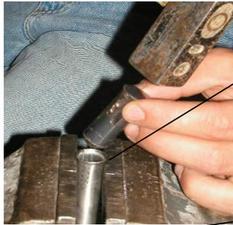
Recourber vers l'extérieur un bord de C13 comme montré sur la photo. Puis l'insérer dans le trou de 16mm dans S1. Recourber maintenant l'autre côté du tube d'acier qui tient alors fermement dans le trou.
