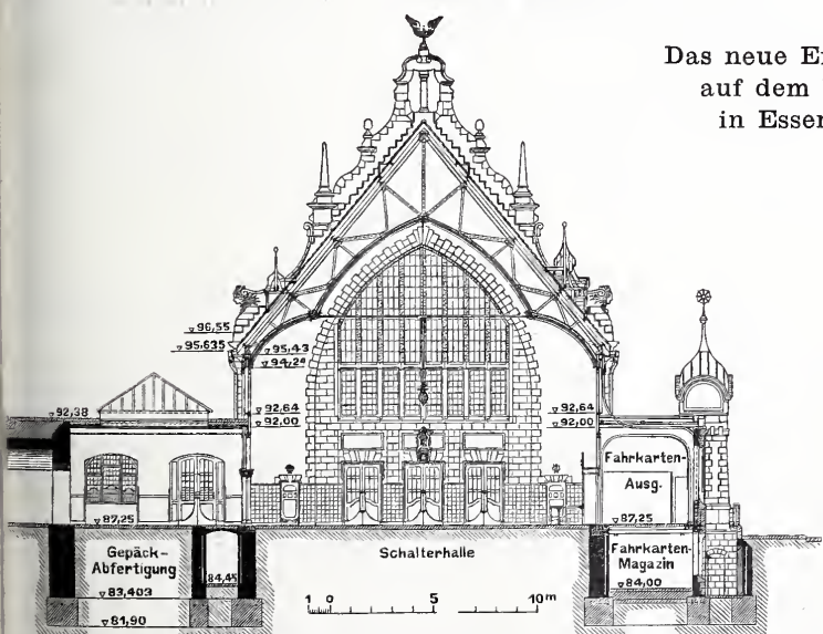
Abb. 7. Schnitt durch die Schalterhalle.
