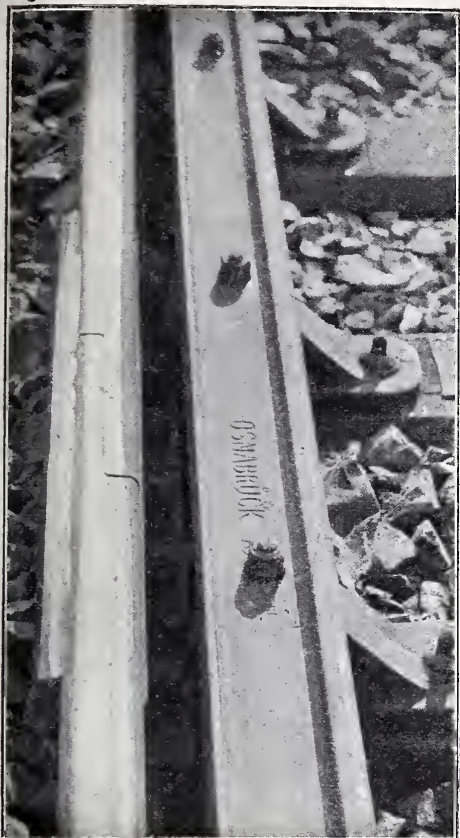
Abb. 17. Schienenstoß mit Radaufwurf im Schnellbahnversuchsgleis Marienfelde-Zossen. Das Aufwurfstück zeigt beginnende Auswölbung und Anbrüche. Alter 2 1/2 Monate.
