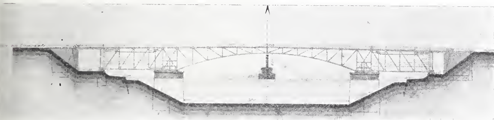
Abb. 10. Doppeldrehbrücke über den Elbe-Travekanal bei Siems.
