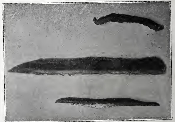
Abb. 15. Übergewalzte und dann abgebrochene Stücke aus dem Kopfe von Stoßfangschiene. Das größte Stück hat eine Länge von 300 mm, eine größte Breite von 80 mm und eine größte Dicke von 8 mm.
