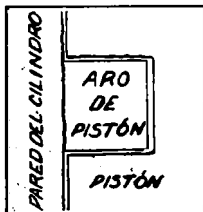
Aspecto áspero de los cilindros, pistones y aros de pistón cuando un automóvil es nuevo
