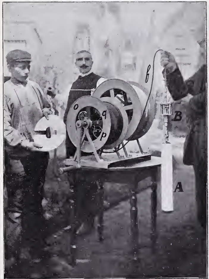
Fig. 2. Electrisch peillood met diepte- en afstandslijnen.
